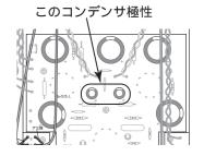
・11ページの工程図の、電解 コンデンサの極性。
