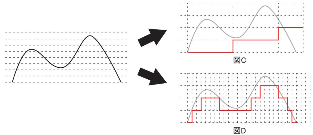
図Cはもとのアナログ量とはぜんぜん違うものになっていますが、図Dは何となく同じような形をしています。このことから、デジタル化するタイミングが短い間隔で多い方が、よりもとのアナログ量に近いデータになることがわかります。
