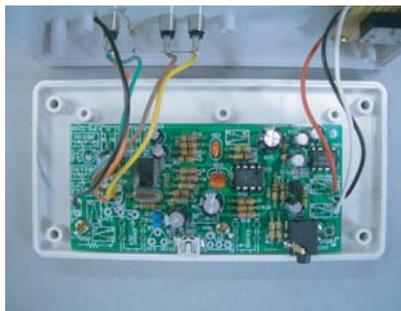
最後にケースの上下を合わせ、シリコンプロテクターをはめてねじ止めすれば完成です！
