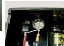
ケースに取り付けた電源ON表示のLEDにも、内側にホットボンドを付けて固定します。
