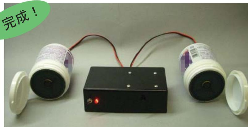
電池ボックスに単3乾電池を2本セットし、ポータブルオーディオプレーヤーなどの音源をステレオミニジャックに接続して使用してください。電源スイッチをONにするとLEDが光り、ボリュームを上げると音楽が聞こえてきます。
