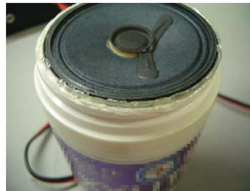
スピーカーをボトルガムケースのふちに合わせ、ホットボンドで取り付けます。ホットボンドがスピーカーのコーン紙に付かないように注意してください。
