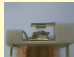
コイルに電流が流れ、CとMが導通している
