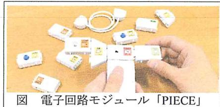
図 電子回路モジュール「PIECE」
